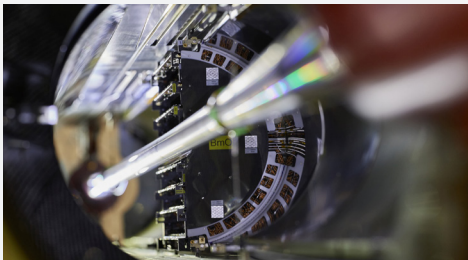
Der neue Pixeldetektor wird direkt um das Strahlrohr in CMS eingesetzt.
