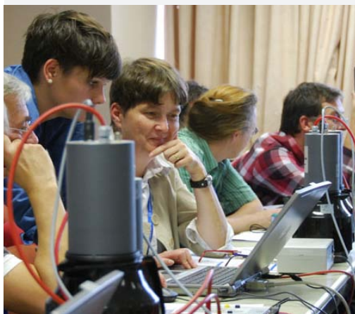
Beim Workshop zu kosmischer Strahlung am CERN messen die TeilnehmerInnen kosmische Myonen mithilfe so genannter Kamiokannen.
