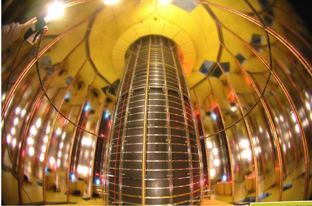
Innerer Bereich des fünf mal fünf Meter großen Feldkäfigs im Herzen der Zeitprojektionskammer des ALICE-Detektors
