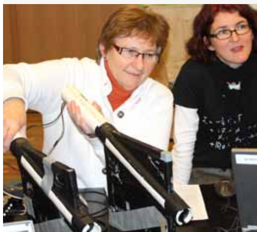
Lehrkräfte bei der Messung kosmischer Teilchen mit einem Szintillationszähler-Experiment.
