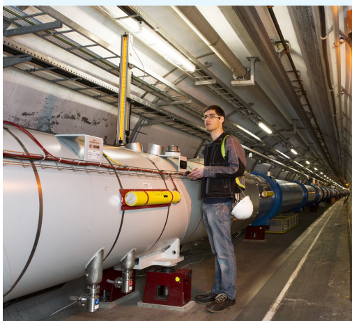
Während des Long Shutdowns 1 (LS1) überprüfen Vermesser die Position der LHC-Magnete im Tunnel.
